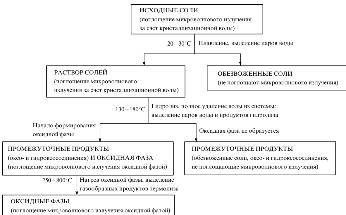
Рис. 16. Схема взаимодействия кристаллогидратов солей металлов с микроволновым излучением.
